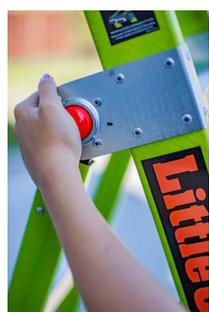
Le mécanisme se déverrouille facilement avec la paume de la main.
