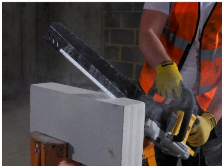
Lames Alligator à utiliser avec DW390 / 391 / 392 / 393 Feuilles de lames en 2 pièces en qualité HSS ou compatibles métal dur pour une performance optimale en cas d'utilisation dans des scies Alligator DeWalt Garantie 3 ans
