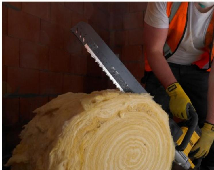
Lames Alligator à utiliser avec DW390 / 391 / 392 / 393 Feuilles de lames en 2 pièces en qualité HSS ou compatibles métal dur pour une performance optimale en cas d'utilisation dans des scies Alligator DeWalt Garantie 3 ans
