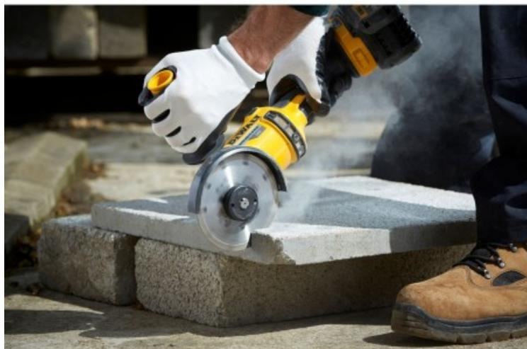
Disques diamant idéal pour la coupe rapide dans le béton Découpe rapide, disque segmenté Coupe rapide à sec des principaux matériaux de construction tels que parpaings, briques, tuiles, bétons de dureté moyenne Coupe rapide à sec des principaux matériaux de construction, comme par exemple parpaings, briques, tuiles, bétons de dureté moyenne Garantie 3 ans
