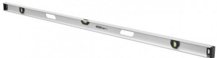
Niveau profilé I-BEAM le plus résistant au monde - Niveau Magnétique pour plus de praticité - 3 fioles monoblocs scellées dans le niveau les rendant indéréglables et très précises - Embouts absorbeurs de chocs à chaque extrémité - Très léger et facile à utiliser grâce à son corps en aluminium - Précision de +/- 0,5mm/m
