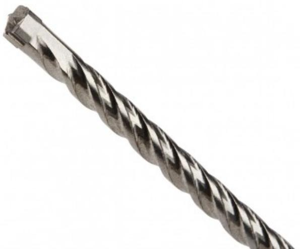
La gamme de forets SDS-Plus XLR possède 4 taillants en carbure pour une plus grande résistance et pour réduire les vibrations. Les quatres hélices permettent une meilleure évacuation des débris pour un perçage plus rapide. Garantie 3 ans
