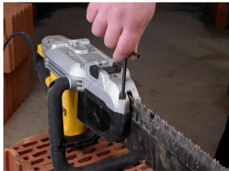
Moteur surpuissant et résistant pour des applications extrêmes - Deux lames de scie durables fonctionnent dans des directions opposées afin que le matériau ne bouge pas pendant la coupe -
