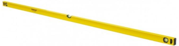
Corps en alu résistant, Bouts antichocs, Précision H: +/- 0.5mm/m Précision V: 1mm/m 1 fiole horizontale et 2 fioles verticales
