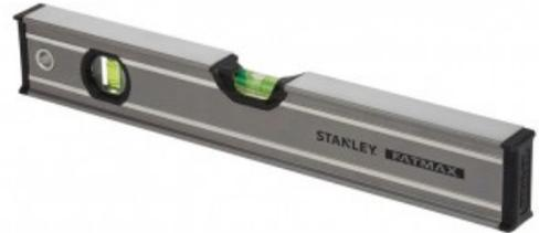
Corps en aluminium léger avec zones de renforcement et peu d'aspérités - Précision : +/- 0,5mm/m - 3 fioles réversibles haute visibilité : 1 horizontale et 2 verticales
