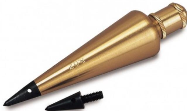
Plomb poli et vernis, anti-rouille - Profil long avec écrou de fixation du cordeau et pointe interchangeable (livré avec 1 pointe de rechange) en acier trempé et trou traversant
