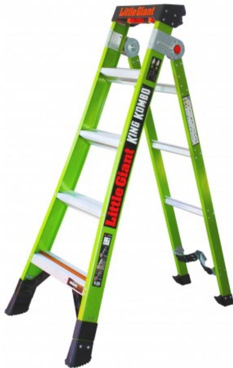
Le King Kombo 4 marches offre une hauteur maximale d'accès de 2,1m en escabeau et de 3m en extension. 3 en 1, à la fois échelle d'appui, escabeau et échelle en extension. En fibre de verre isolée. Équipé du Wallpad rotatif pour prendre appuis sur les murs et angles ouverts ou fermés. Équipé du système GroundCue pour réduire les risques d'accidents. Pieds en caoutchouc antidérapants et renforcés.
