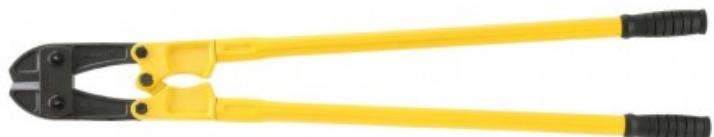
Acier allié forgé (chrome-molybdène) assurant robustesse et tenue de coupe - Pièces forgées pour plus de puissance - Capacité de coupe maximale de 10mm à 160kg/mm<sup>2</sup>
