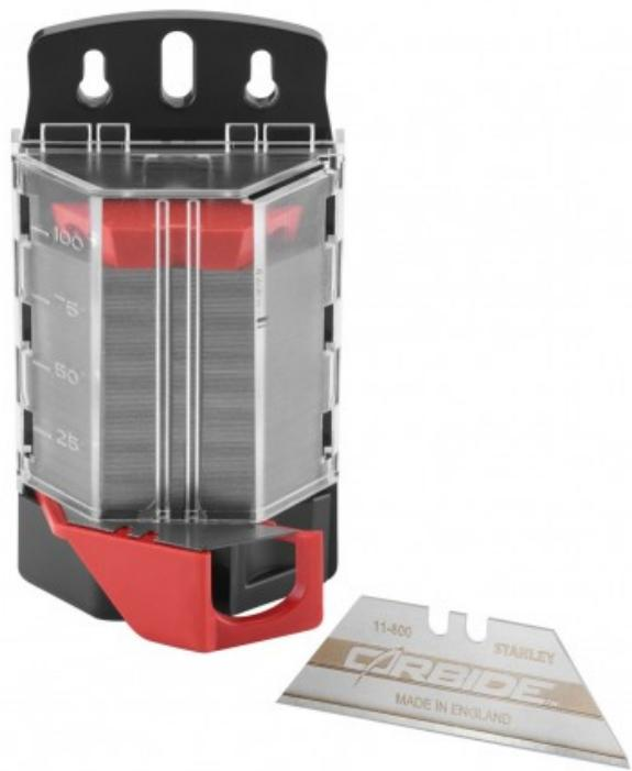
Amélioration de la durabilité de la lame: le tranchant dure 10 fois plus longtemps que les lames classiques. Une couche de Carbure de Tungstène est déposée par un laser haute puissance sur le tranchant de la lame pour en améliorer sa résistance à l'abrasion. Le Carbure de Tungstène est le matériau le plus dur et le plus durable après le diamant. Seul le tranchant est recouvert, ce qui laisse à la lame une bonne flexibilité
