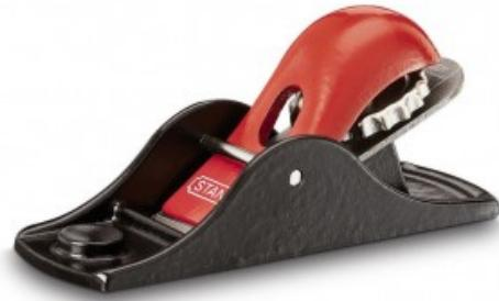
Rabot à fût en fonte et semelle rectifiée - Réglage manuel simple de la profondeur du fer et de gauchissement - Position du fer à 21°
