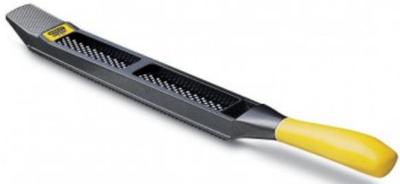
Corps métallique - Utilise tout type de lame de longueur 255mm - Remplace la râpe classique pour de nombreux travaux d'usinage - de retouche -
