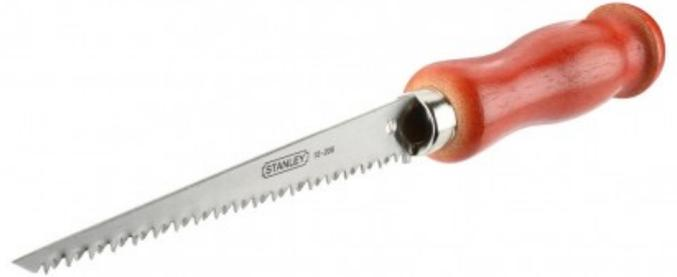
Denture 6 dents/pouce - Pointe en bout de lame pour amorcer la coupe - Lame étroite à denture isocèle - rigide ne fouettant pas pendant la coupe
