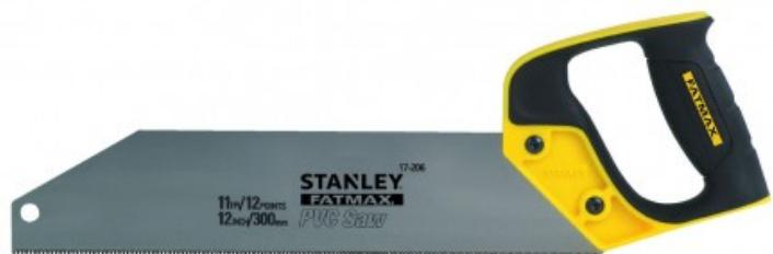
Traitement denture Hard Point 2x pour : Longévité de coupe accrue - Meilleure pénétration - Denture spécifique 11 dents/pouce : sciage rapide et net - plus besoin d'ébavurer les tubes - Épaisseur de lame de 0.86 mm : précision de coupe améliorée - évite le flambage de la lame
