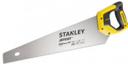
Traitement de denture Hard Point 2x avec voyage alterné pour : Longévité accrue et meilleure pénétration - Denture fine 11 dents/pouce = coupe en travers - Lame en acier de qualité suédoise de 0,85mm d'épaisseur
