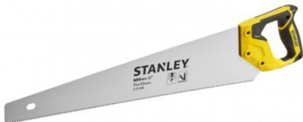
Traitement de denture Hard Point 2x avec voyage alterné pour : Longévité accrue et meilleure pénétration - Denture fine 11 dents/pouce = coupe en travers - Lame en acier de qualité suédoise de 0,85mm d'épaisseur
