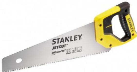
HP 7 dents/pouce - Épaisseur de lame de 0.85 mm pour éviter le flambage de la lame - Denture "hardpoint" - affûtage permanent
