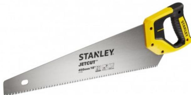
HP 7 dents/pouce - Épaisseur de lame de 0.85 mm pour éviter le flambage de la lame - Denture "hardpoint" - affûtage permanent
