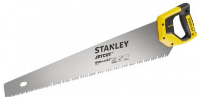
Traitement denture Hard Point 2x avec voyage alterné pour : Longévité de coupe accrue - Meilleure pénétration - Denture 7 dents/pouce - Lame en acier de qualité suédoise de 0,85mm d'épaisseur
