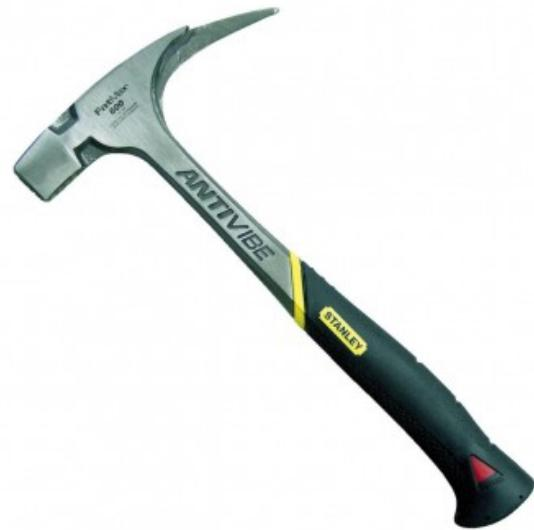
Tête et manche forgés d'une seule pièce pour plus de confort - Tête plate quadrillée - Système Antivibe "diapason" d'amortissement des vibrations et diminue la fatigue de l'utilisateur - Traitement thermique anti-éclats de la zone de frappe
