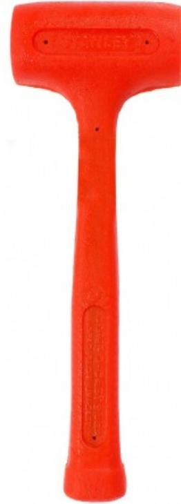
Massettes à tête douce - Anti-rebond : des centaines de billets d'acier se déplacent dans la tête permettant d'appuyer le choc et de contrôler la frappe - Anti-déflagration : pas d'étincelle à la frappe
