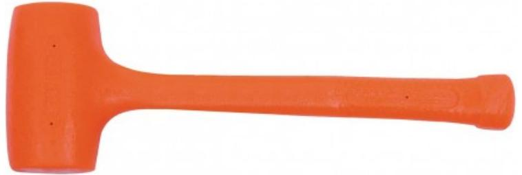
Massettes à tête douce - Anti-rebond : des centaines de billets d'acier se déplacent dans la tête permettant d'appuyer le choc et de contrôler la frappe - Anti-déflagration : pas d'étincelle à la frappe
