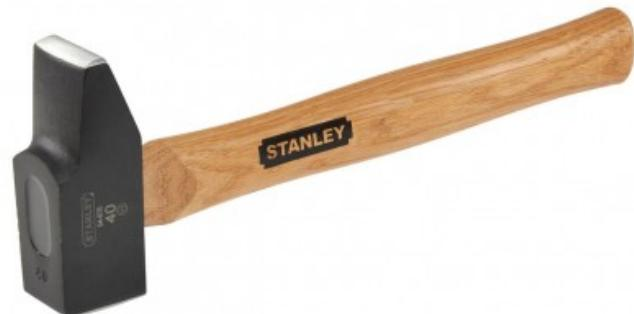
Manche en frêne de haute qualité - Emmanchement en force associé à une résine de collage et d'étanchéité - Panne bombée en acier forgé pour : travaux mécaniques - constructions métalliques - dressage de profilés
