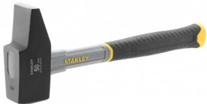
Liaison Epoxy de la tête -Manche en fibre de verre plus large pour donner plus de force-Manche bimatière nervuré pour une meilleure prise en main-Grip étendu pour un balancement optimum et meilleure ergonomie de la poignée-Répartition du poids du marteau pour plus d'efficacité : Maximisation de la force du coup et donc moins de fatigue pour l'utilisateur
