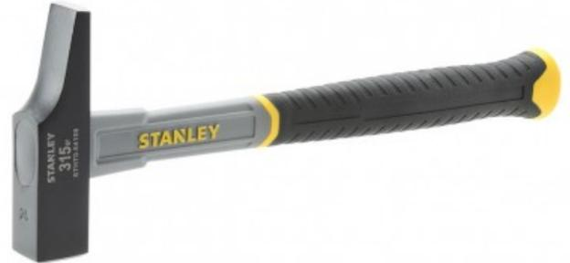
Liaison Epoxy de la tête -Manche fibre de verre plus large pour donner plus de force-Manche bi-matière nervuré pour une meilleure prise en main-Grip étendu pour un balancement optimum et meilleure ergonomie de la poignée-Répartition du poids du marteau pour plus d'efficacité : Maximisation de la force du coup et donc moins de fatigue pour l'utilisateur
