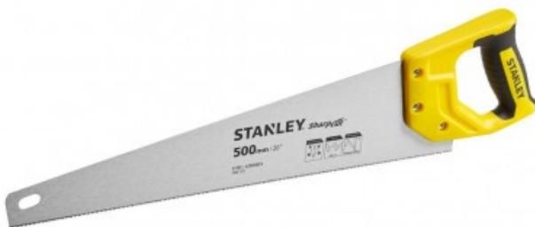
Lame en acier de 0,85 mm d'épaisseur - Denture Universelle double biseau de 7 à 11 dents/pouce pour des coupes fines en long ou en travers - Traitement de denture Hard Point 2x avec voyage alterné pour : Longévité de lame accrue et meilleure pénétration - Emplacement doigt optimisé pour une meilleure prise et confort - Guide 45° and 90°
