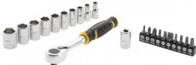
1 Cliquet 120 dents ¼" FATMAX - 10 Douilles ¼" (12 pans) : 5,5 – 6 – 7 – 8 – 9 – 10 – 11 – 12 – 13 – 14 mm sur rack métallique - 1 Porte-embouts - 10 Embouts de vissage ¼" : PH0 – PH1 - PH2 - TT15-TT20-TT25-TT30 – Fente : 3,5-4,5-8 - Cliquet 120 dents pour un angle de reprise de 3°-Tête très compacte-Large bouton de déverrouillage en métal à faible épaisseur-Levier d'inversion compact, encastré
