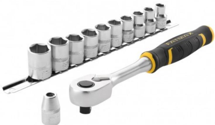
1 Cliquet 120 dents 3/8" FATMAX + 10 Douilles 3/8" (12 pans) : 8 – 9 – 10 – 11 – 12 – 13 – 14 – 15 – 16 – 17 mm sur rack métallique + 1 Porte-embout 3/8" pour embouts de visage ¼" + 10 Embouts de visage ¼" : PH0 – PH1 - PH2 –TT15-TT20-TT25-TT30-Fente : 3,5-4,5-8- Cliquet 120 dents pour un angle de reprise de 3°-Tête très compacte-Large bouton de déverrouillage en métal à faible épaisseur-Levier d'inversion compact, encastré
