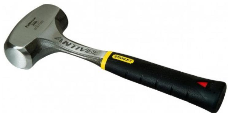
Tête et manche forgés d'une seule pièce pour plus de confort - Système "diapason" d'amortissement des vibrations et diminue la fatigue de l'utilisateur - Traitement thermique anti-éclats de la zone de frappe pour une sécurité accrue
