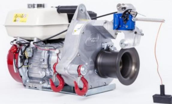
Treuil de tirage et levage à essence. Il a une force de tire max de 1000kg et une capacité de levage de 450kg, pouvant être doublé avec l'usage d'une poulie. Il pèse 34,5kg et a une vitesse de 12m/min. Motorisation Honda 4 temps GXH-160cc. Système intégré de retenue de la corde permettant à l'opérateur de travailler en toute sécurité.
