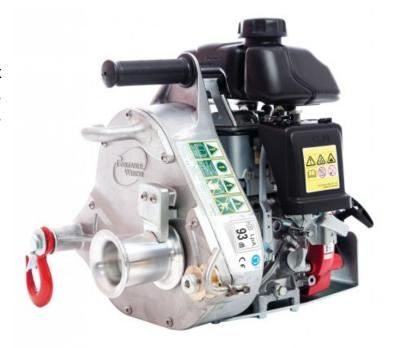
Treuil de tirage à essence. Il a une force de tire max de 1000kg et pèse 16kg. Sa vitesse de tire est de 12m par minutes. Motorisation honda 4 temps GXH-50cc. 2 options de vitesse en changeant le tambour de 57mm par un de 85mm tirant 18m par minutes. Le diamètre idéal de la corde est de 12mm
