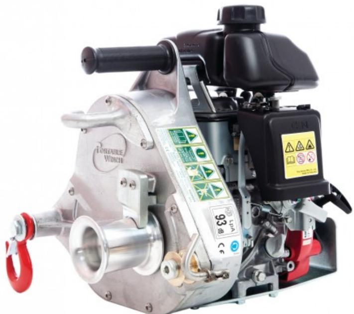
Treuil de tirage à essence. Il a une force de tire max de 1000kg et pèse 16kg. Sa vitesse de tire est de 12m par minutes. Motorisation honda 4 temps GXH-50cc. 2 options de vitesse en changeant le tambour de 57mm par un de 85mm tirant 18m par minutes. Le diamètre idéal de la corde est de 12mm
