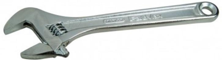
Clé forgée à partir d'acier chrome vanadium - Finition anti-corrosion : nickel et chrome - 5 dimensions : 150 mm - 200 mm - 250 mm - 300 mm - 375 mm - Conforme aux normes ISO 6787 et DIN 3117 - Poignée large apportant plus de confort - Ouverture maximale à 34 mm - Marquage gravé au laser pour un ajustement précis
