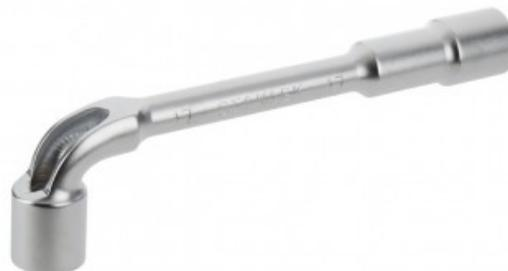
Clé forgée - Acier chrome vanadium de qualité supérieure avec traitement thermique - Finition : Chrome Mat - Débouchage permettant le passage d'une tige filetée ou l'usage d'une broche pour augmenter le couple de serrage
