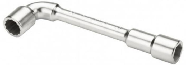
Clé forgée - Acier chrome vanadium de qualité supérieure avec traitement thermique - Finition : Chrome Mat - Débouchage permettant le passage d'une tige filetée ou l'usage d'une broche pour augmenter le couple de serrage
