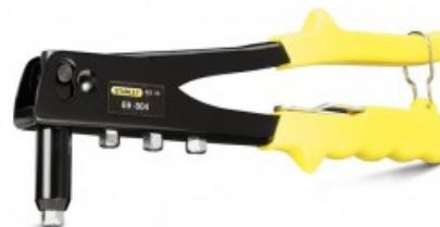
Bec à 90° - 4 buses interchangeables diamètre 2-3-4-5 mm - Usage occasionnel - Ejection automatique de la tige du rivet - Clé à buse incorporée - Livrée avec une sélection de 15 rivets en aluminium
