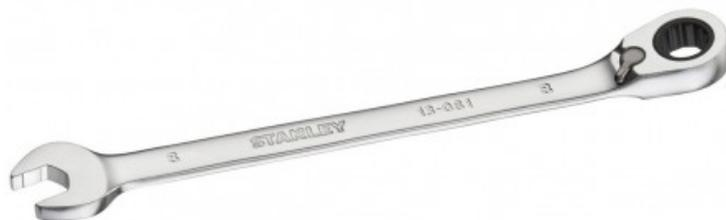
Fourche orientée à 15°- Système « anti slip » sur la fourche - Améliore l'adhérence de la fourche sur la tête de vis - Prise de l'écrou sur 3 points - Œil 12 pans orienté à 15° pour les accès de côté - Mécanisme à cliquet pour ne pas avoir à repositionner la clé et gagner du temps-72 dents pour un angle de reprise 5 ° pour travailler dans zone exigüe-Le système inversion permet de ne pas avoir à retourner la clé - Finition chrome mat pour une meilleure résistance à la corrosion
