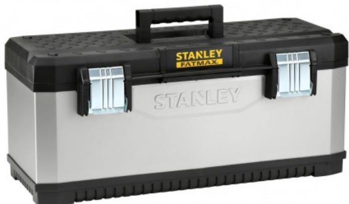
Structure bi matière: Métal + Polypropylène - Axe de charnière métal en une seule pièce sur toute la longueur du couvercle - Larges attaches métalliques anticorrosion
