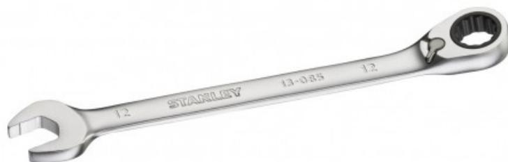
Fourche orientée à 15°- Système « anti slip » sur la fourche - Améliore l'adhérence de la fourche sur la tête de vis - Prise de l'écrou sur 3 points - Œil 12 pans orienté à 15° pour les accès de côté - Mécanisme à cliquet pour ne pas avoir à repositionner la clé et gagner du temps-72 dents pour un angle de reprise 5 ° pour travailler dans zone exigüe-Le système inversion permet de ne pas avoir à retourner la clé - Finition chrome mat pour une meilleure résistance à la corrosion
