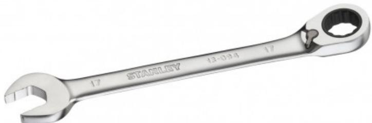
Fourche orientée à 15°- Système « anti slip » sur la fourche - Améliore l'adhérence de la fourche sur la tête de vis - Prise de l'écrou sur 3 points - Œil 12 pans orienté à 15° pour les accès de côté - Mécanisme à cliquet pour ne pas avoir à repositionner la clé et gagner du temps-72 dents pour un angle de reprise 5 ° pour travailler dans zone exigüe-Le système inversion permet de ne pas avoir à retourner la clé - Finition chrome mat pour une meilleure résistance à la corrosion
