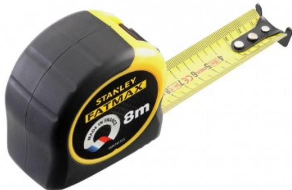
Revêtement Blade Armor thermoplastique pour une protection optimale du ruban sur les 8 premiers centimètres : limite l'usure et diminue de 95% le risque de casse du ruban - Ruban ultra épais de 0,13mm - Revêtement polyester haute protection et anti-abrasion sur la totalité du ruban
