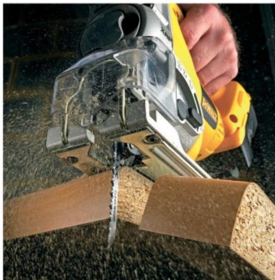
Acier de première qualité offrant une durabilité maximale et une durée de vie supplémentaire avec un corps de lame renforcé permettant une maîtrise et une précision optimales
