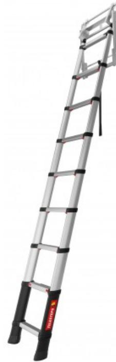
L'échelle de grenier la plus astucieuse du marché. Facile à installer et à utiliser, n'exigeant qu'une toute petite trappe de grenier. Larges marches confortables. Profilage des marches minimisant les risques de dérapage. Rainurage améliorant le contact. Vêrouillage simple et dur. Echelle fabriquée en aluminium anodisé haute qualité, avec raccords en plastique renforcés par de la fibre de verre.
