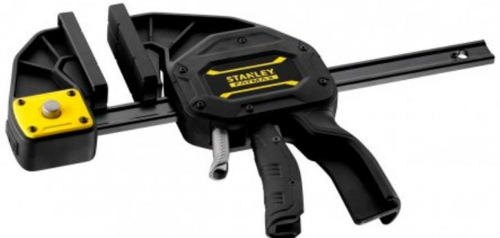
Puissance de serrage 270kg/m<sup>2</sup> - Se transforme facilement en écarteur : déblocage des mâchoires par simple pression sur le bouton - Gâchette de desserrage en métal-Poignée ergonomique anti-dérapante-Structure poignée en métal-Rail en acier en I-Corps en nylon renforcé-Rainures en V croisées sur le patin - Patins de protection de grande dimension
