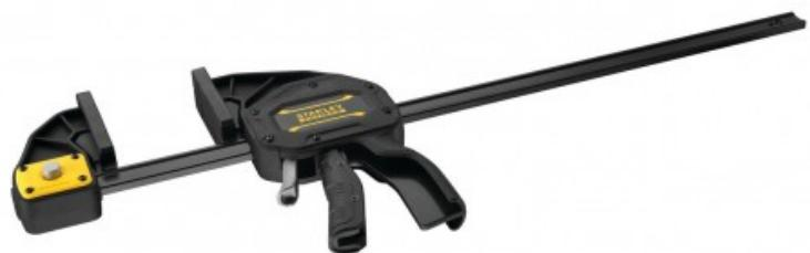
Puissance de serrage 270kg/m<sup>2</sup> - Se transforme facilement en écarteur : déblocage des mâchoires par simple pression sur le bouton - Gâchette de desserrage en métal-Poignée ergonomique anti-dérapante-Structure poignée en métal-Rail en acier en I-Corps en nylon renforcé-Rainures en V croisées sur le patin - Patins de protection de grande dimension
