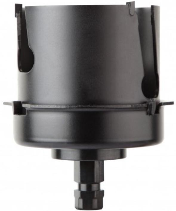
Scie trépan polyvalente permettant de percer une grande variété de matériaux. S'utilise sur perceuse ou perforateur via un pilote avec foret (système onehand) permettant un gain de temps important grâce au verrouillage et au déverrouillage de la scie en 1 seul geste.
