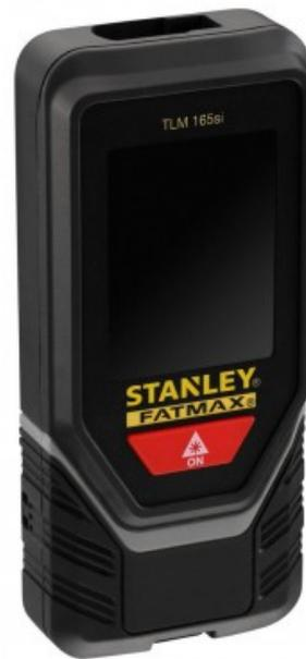
Mesure Laser + Étui + Piles-Portée : 0,10m à 60m - Précision : +- 1.5mm - Dimensions : 104 x 58,8 x 29,6 mm / 110 g - Toutes les fonctions de second œuvre dans un mini volume
