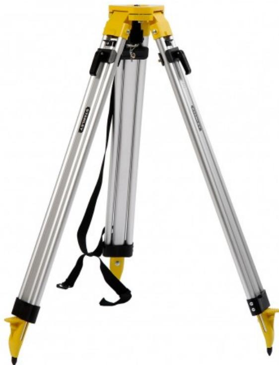
Profilé aluminium - Blocage des pieds par système “quick clamps” - Plage d'utilisation de 97 à 160 cm - Sangle de transport - Charnières fixées par vis - Filetage 5/8” - Tête large pour plus de stabilité avec gros laser
